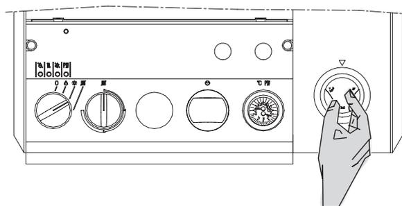
Per lo spegnimento portate il selettore di funzione sul simbolo «0» togliendo tensione alla caldaia, chiudere la manopola del rubinetto del gas posto sotto la caldaia.
