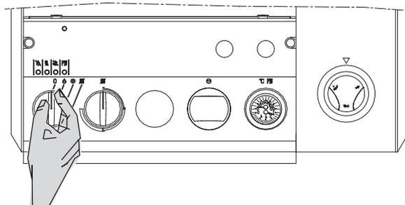
AccertarVi, ad inizio di stagione di riscaldamento, che il termoidrometro (strumento posto sul cruscotto della caldaia), abbia valori di pressione a impianto freddo, compresi tra 0,6 bar a 1,5 bar (6 e 15 m H<sub>2</sub>O - scala in colore azzurro), **per evitare rumorosità dell'impianto dovuta a presenza d'aria. La caldaia si fermerà in caso di circolazione d'acqua insufficiente.»**
