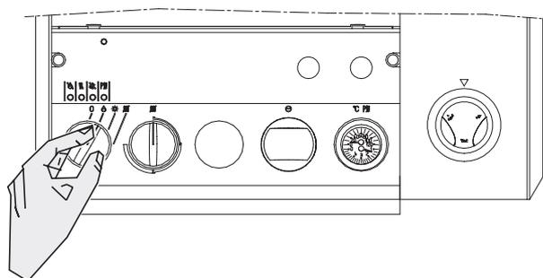
Ruotare la manopola del selettore temperatura acqua riscaldamento sulla posizione desiderata (tenendo presente che la posizione al minimo corrisponde a circa 45° C, mentre al massimo a circa 85° C).
