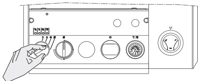
Ruotando la manopola del miscelatore di temperatura dei servizi potete scegliere temperature di erogazione dell'acqua sanitaria che vanno da circa 32° C (posizione min.) a circa 60° C (posizione max.). Sulla manopola sono inoltre indicate 2 posizioni raffigurate con i simboli "Y" e "E" che corrispondono alle posizioni di normale utilizzo.
