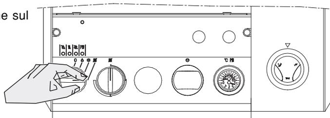
Se il led che indica il funzionamento generale è verde, la caldaia funziona regolarmente (procedere con le altre operazioni), se lo stesso è rosso lampeggiante la caldaia ha una anomalia di funzionamento (vedere paragrafo funzionamento).
