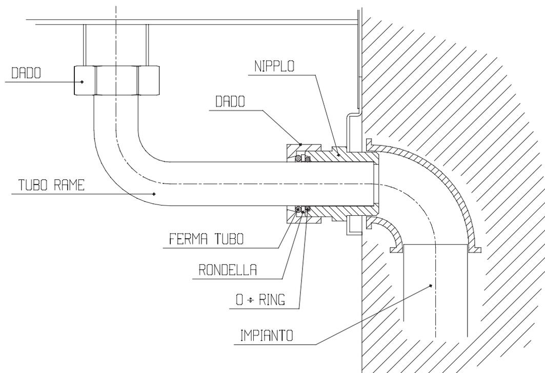
Dopo aver montato la manopola di riempimento ed effettuato il collaudo delle tubazioni, è possibile montare la copertura dei collegamenti.
