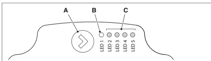
L'interfaccia utente permette di visualizzare le prestazioni in funzionamento (stato funzionamento e stato allarme) e impostare le modalità di funzionamento del circolatore.
