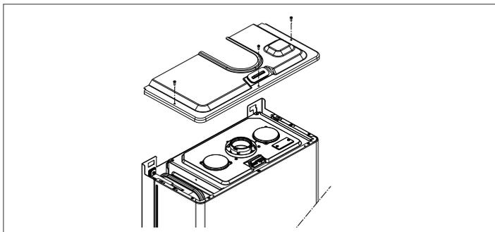
I condotti sdoppiati possono essere orientati nella direzione più adatta alle esigenze dell'installazione. Il condotto di aspirazione dell'aria comburente va collegato all'ingresso dopo aver rimosso il tappo di chiusura fissato con tre viti e fissato l'apposito adattatore. Il condotto scarico fumi deve essere collegato all'uscita fumi dopo aver installato l'apposito adattatore. Per l'installazione seguire le istruzioni fornite con il kit accessorio specifico per caldaie a condensazione.
