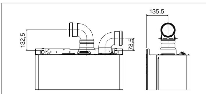
Per il fissaggio del condotto ø 80 rimuovere definitivamente la copertura superiore agendo sulle viti di fissaggio.
