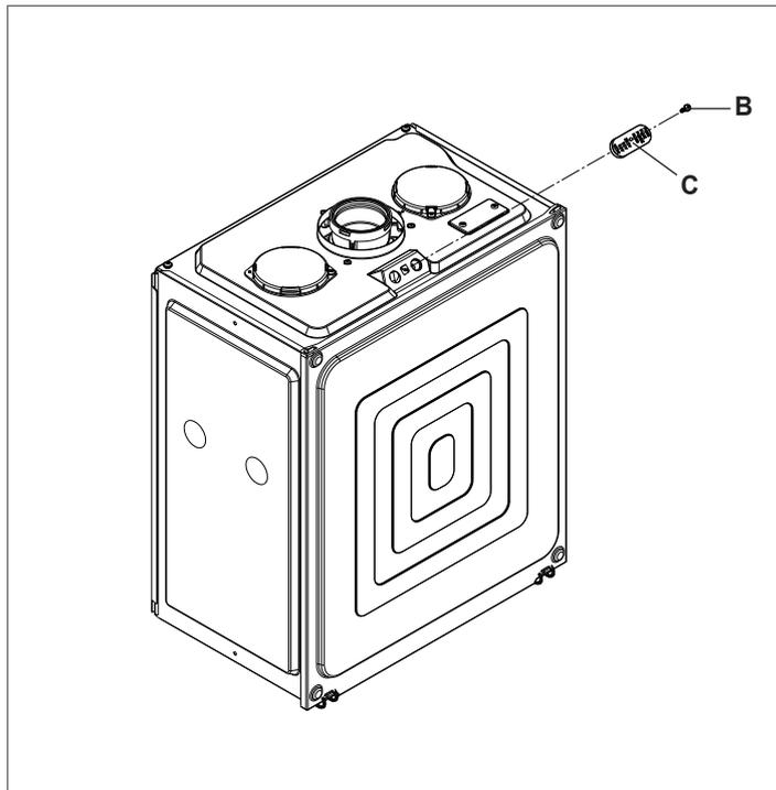
**!** La sonda per l'analisi dei fumi deve essere inserita fino a arrivare in battuta
