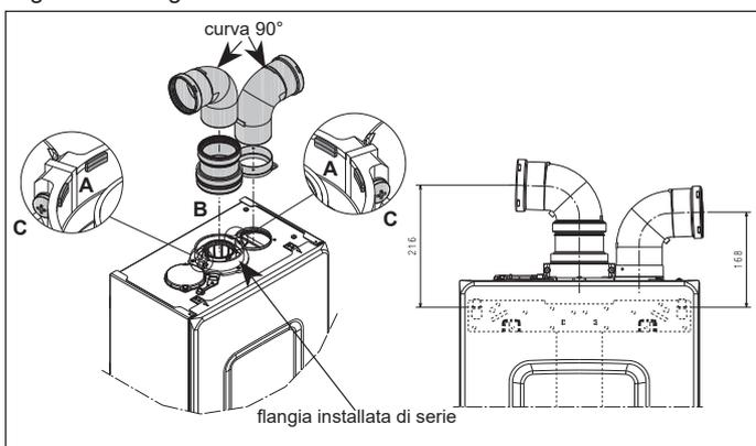
In caso si utilizzi il kit sdoppiatore da  $\varnothing 60-100$  a  $\varnothing 80-80$  al posto del sistema sdoppiato, si determina una perdita nelle lunghezze massime come indicato in tabella.
