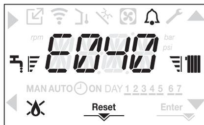
Chiudere successivamente il rubinetto di riempimento (esterno alla caldaia) assicurandosi di sentire lo scatto meccanico. Al termine del caricamento procedere con il ciclo di sfiato automatico come descritto nel paragrafo "3.11 Riempimento dell'impianto di riscaldamento ed eliminazione dell'aria".
