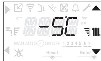
Nota: in presenza di sonda esterna collegata è comunque possibile far lavorare la caldaia a punto fisso andando ad impostare il parametro P4.18=0 (menu P4).
