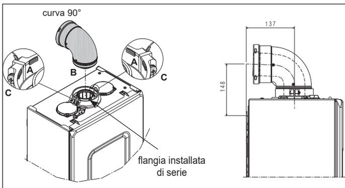
Posizionare lo sdoppiatore in modo che l'innesto  $\varnothing 60$  vada completamente in battuta nella torretta fumi della caldaia.
