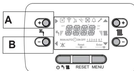
La successiva pressione dei tasti A o B consente di impostare il valore del setpoint sanitario incrementandolo o decrementandolo all'interno del range prestabilito, con step di 0.5°C.
