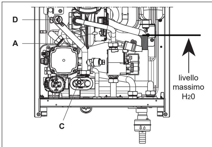
NOTA: le operazioni di riempimento dell'impianto devono essere fatte agendo sul rubinetto di riempimento (esterno alla caldaia) con caldaia in stato OFF.
