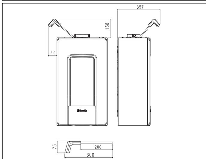
**!** In caso di installazione è **INDISPENSABILE** prevedere gli spazi necessari per l'introduzione dello strumento per l'analisi combustione. Riportiamo un disegno campione dove le distanze tra caldaia e pensile/nicchia sono state ottenute utilizzando uno strumento di lunghezza 300 mm. Strumenti di lunghezze superiori necessitano di spazi maggiori.
