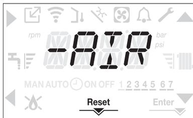
Per interrompere il ciclo di sfiato premere il tasto RESET. Portare la caldaia in stato OFF premendo il tasto ⏻.
