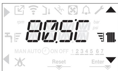
Tenendo premuto a lungo uno dei due tasti C oppure D, il contatore aumenterà la velocità di avanzamento modificando il valore impostato. Se nessun tasto viene premuto per 5sec, il valore impostato è assunto come nuovo setpoint riscaldamento e la visualizzazione torna alla schermata principale.
