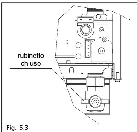
Chiudere quindi il rubinetto del gas posto sotto la caldaia, ruotando la manopola in senso orario (fig. 5.3).
