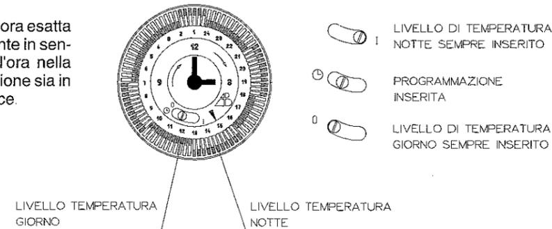
**N.B.:** L'orologio programmatore è dotato di riserva di carica di 150 ore. Per il suo funzionamento continuo occorre che la caldaia sia sempre alimentata. In caso di mancanza di tensione oltre le 150 ore rimettere l'orologio all'ora esatta.
