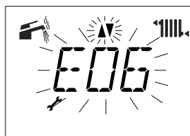
Figura 3.7 LCD guasto permanente.
