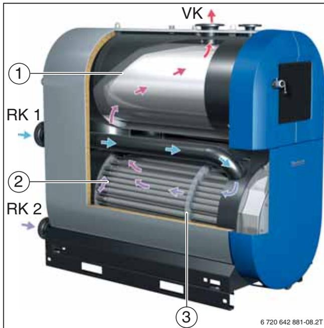
Fig. 9 Schema di funzionamento del corso dell'acqua calda sanitaria nella caldaia a condensazione Logano plus SB745
