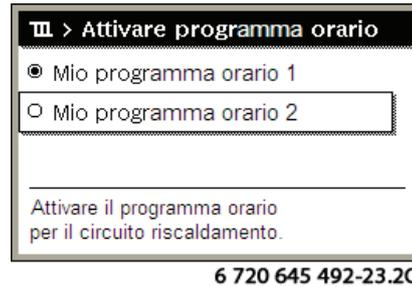
Il termoregolatore funziona in automatico con il programma orario selezionato. Se sono installati 2 o più circuiti di riscaldamento, l'impostazione è valida solo per il circuito di riscaldamento selezionato.
