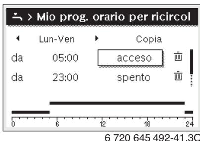
Se la pompa di ricircolo è attiva (**on**) secondo il programma orario, la pompa di ricircolo funziona in base alle impostazioni in **Frequenza di avviamento**.
