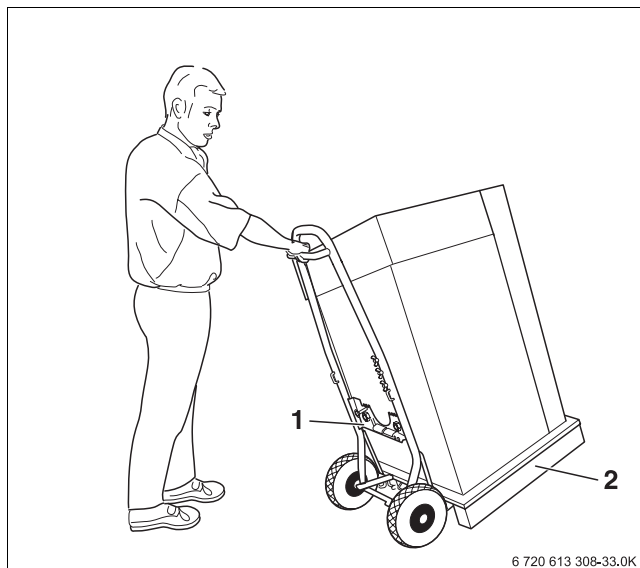
Fig. 7 Fissare la caldaia al carrello di trasporto
