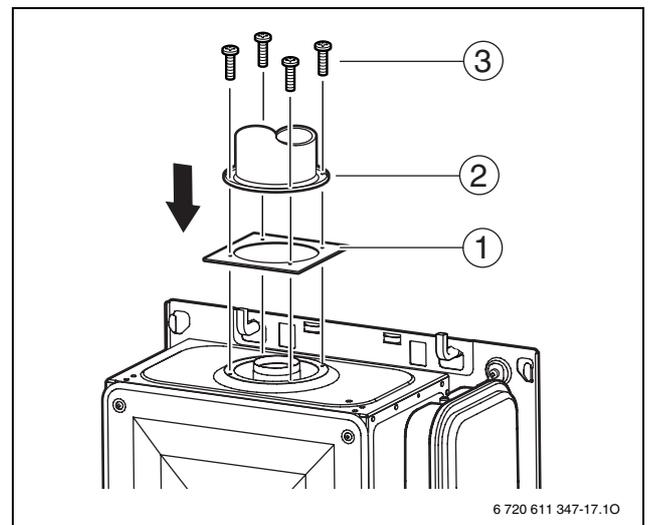
Fig. 18 Fissaggio dell'adattatore di aspirazione/scarico (esempio Ø 80 mm)
