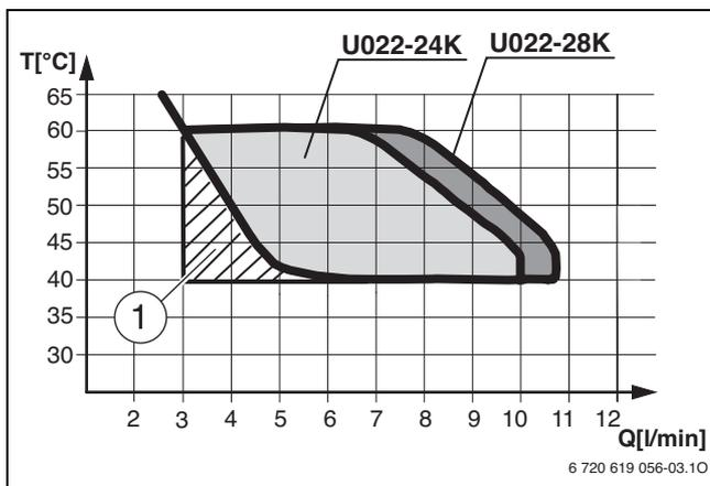
Fig. 34 Diagramma per una temperatura in entrata dell'acqua fredda di +10 °C
