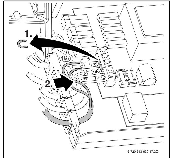
Fig. 25 Collegamento (230 V CA, rimuovere il ponticello tra TH1 e TH2)
