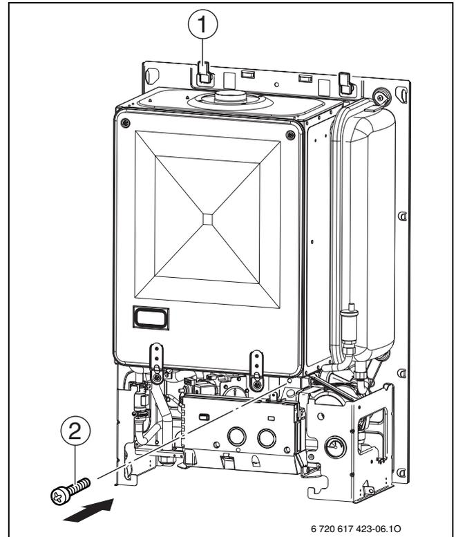
Fig. 12 Fissaggio a muro
