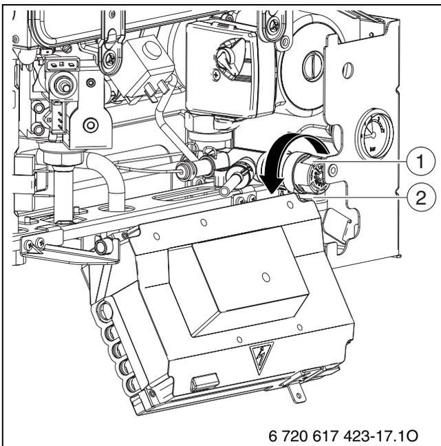
Fig. 51 Valvola di sicurezza riscaldamento
