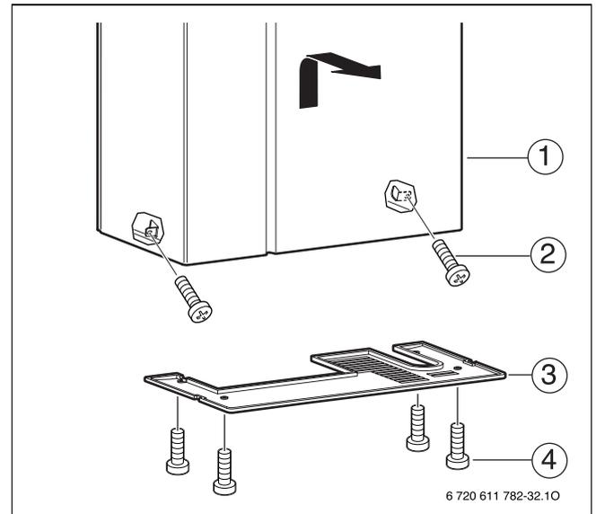
Fig. 44 Rimuovere la copertura inferiore e il rivestimento
