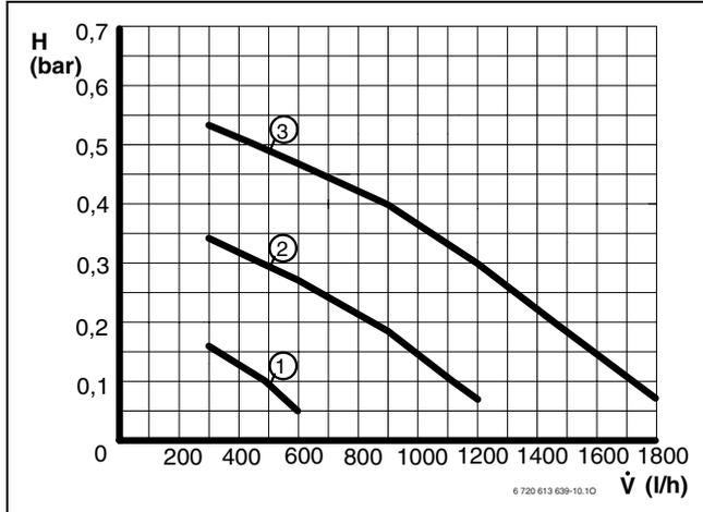
Fig. 33 Diagramma delle curve caratteristiche/velocità del circolatore
