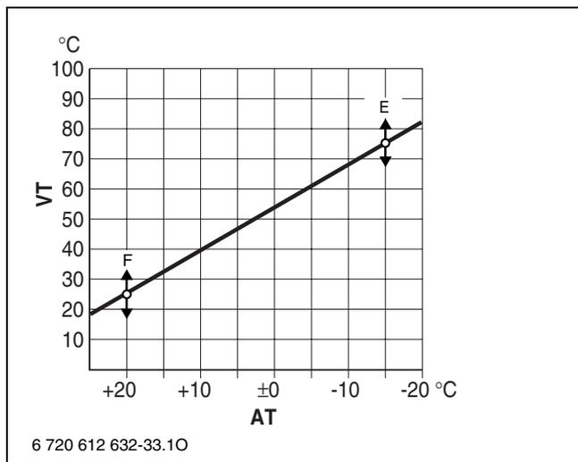
Fig. 32 Curva di riscaldamento
