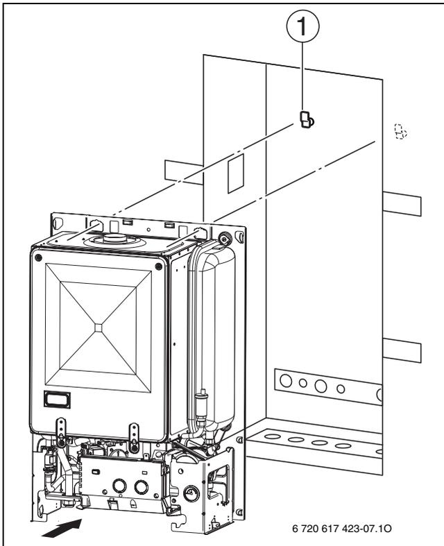
Fig. 13 Fissaggio a muro nel box per incasso
