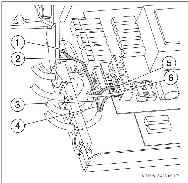
Fig. 26 Collegamento cavo 230 V AC
