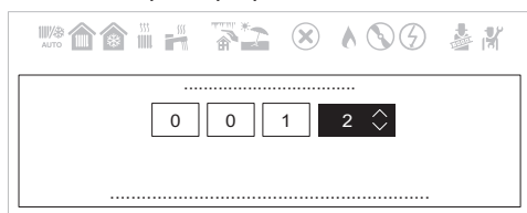
Obr.41 Kód přístupu pro servis
