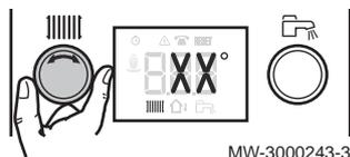
1. Impostare il setpoint temperatura o la temperatura ambiente secondo la configurazione descritta in precedenza ruotando la manopola
