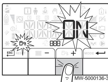
2. Selezionare la modalità di produzione di acqua calda sanitaria premendo il tasto **+**.
