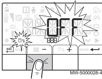
4. Selezionare la modalità di produzione di acqua calda sanitaria premendo il tasto **-**.
