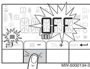
2. Selezionare la modalità di riscaldamento mediante pressione sul tasto **—**.
