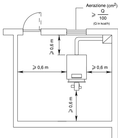
Tra il soffitto e l'involucro della caldaia deve intercorrere una distanza di almeno un metro. Per caldaie con bollitore incorporato la distanza fra l'involucro del bollitore stesso ed il soffitto deve essere non inferiore a 0,50 m.
