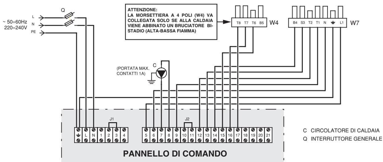
**19.1.3 SCHEMA DI COLLEGAMENTO ELETTRICO AL PANNELLO DI COMANDO DELLE CALDAIE TRIMAX CON BRUCIATORE TRIFASE**
