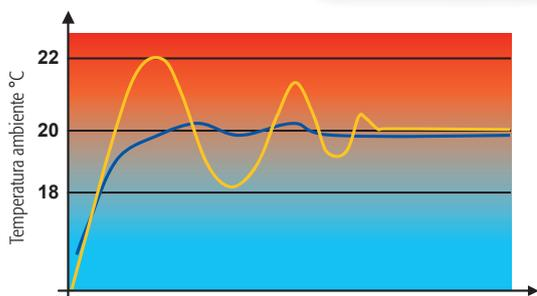
La funzione modulante di ROMEO consente una modulazione della potenza della caldaia man mano che si tende a raggiungere il valore della temperatura ambiente impostato. Ciò migliora la qualità del comfort eliminando i picchi di calore e permette un certo risparmio energetico.
