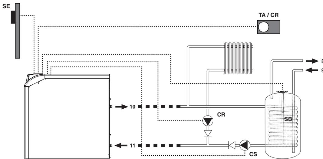
La serie PEGASUS D è stata progettata per poter gestire direttamente con l'elettronica di serie il circolatore per un impianto diretto di riscaldamento e uno per il serpentino di un bollitore ad accumulo sanitario. Sono inoltre previsti ingressi per il sensore sanitario, la sonda esterna, il cronocomando remoto o in alternativa un termostato ambiente di tipo ON/OFF.
