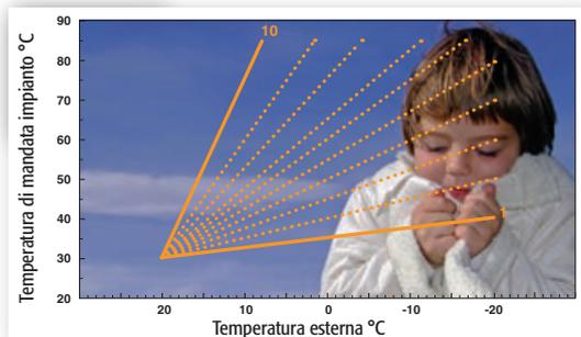
Con l'installazione del kit "SONDA ESTERNA" è possibile far funzionare la caldaia in temperatura scorrevole. Ciò significa che senza agire sui tasti di regolazione della temperatura di impianto, la caldaia si autoregolerà in funzione delle variazioni delle temperature esterne. Ciò si traduce in un risparmio energetico pur garantendo il massimo comfort all'u tente.
