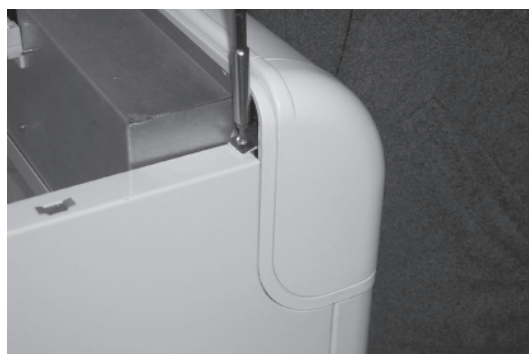
Fig. 5 - Dévisser les deux boulons et les deux plaquettes fixant le panneau de commande.
