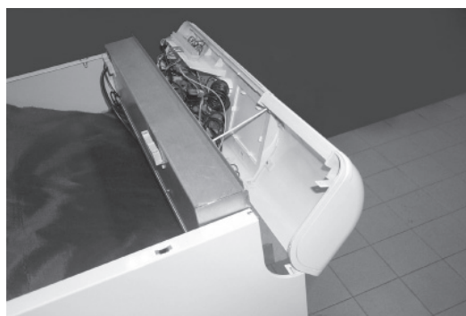
Fig. 6 - Faire tourner vers l'avant le panneau de commande.
