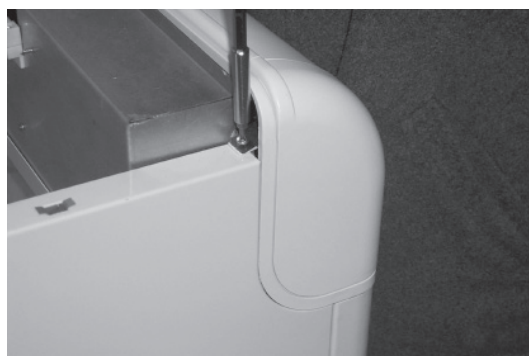
Fig. 5 - Svitare e togliere le due viti e le due piastrine che trattengono il pannello comandi.
