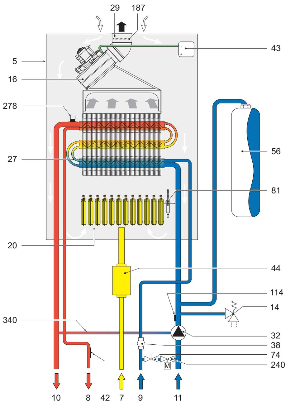
fig. 31 - Circuito idraulico
