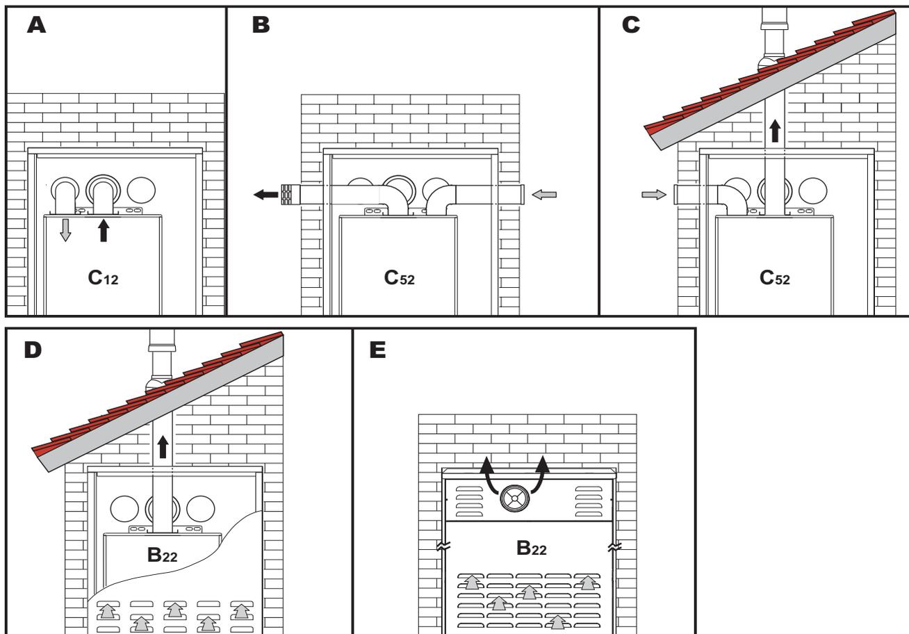
fig. 21 - Esempi di collegamento con tubi separati (⇨ = Aria / ⇨ = Fumi)
