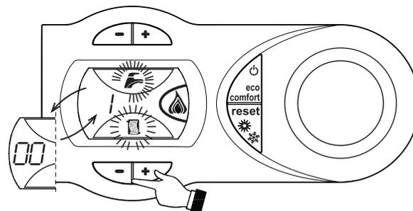
fig. 25 - Modalità TEST (potenza riscaldamento = 100%)
