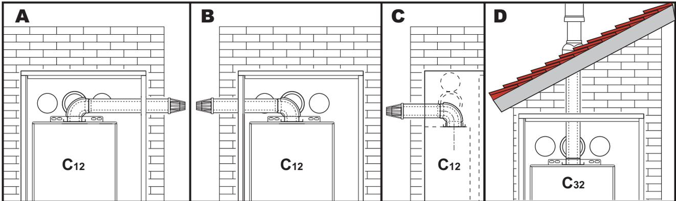
fig. 19 - Esempi di collegamento con tubi coassiali
