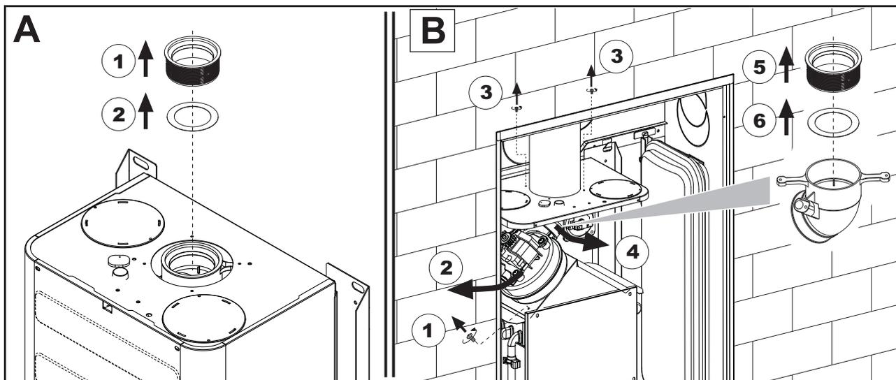
fig. 18 - Sostituzione diaframma (A = Con caldaia non installata / B = Con caldaia e condotti fumo già installati)
