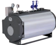
PREX N ASH 160 - 3.500 kW Caldaia per acqua surriscaldata fino a 200°C, a tre giri di fumo di cui due in camera di combustione.
