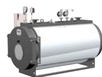
PREX N ASL 1.000 - 3.500 kW Caldaia per acqua surriscaldata fino a 145°, a tre giri di fumo di cui due in camera di combustione. Superheated water boiler max temperature 145°, with three flue passes, two in furnace.
