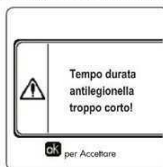
fig. 27- Mensaje Función Antilegionela no finalizada
