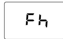
fig. 7 - Sfiato con ventilatore spento
