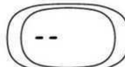
wygląd 2- Wyłączenie kotła
