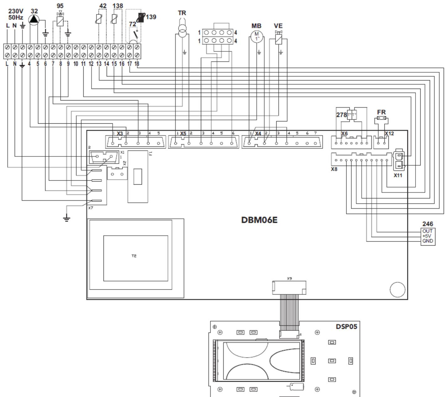
fig.44 - Schema elettrico
