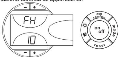
fig.6 - Accensione caldaia
