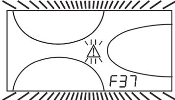
fig.16 - Anomalia pressione impianto insufficiente
