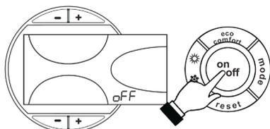
fig.7 - Spegnimento caldaia
