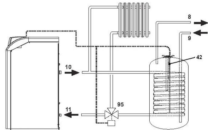
fig.20 - Schema collegamento ad un bollitore esterno
