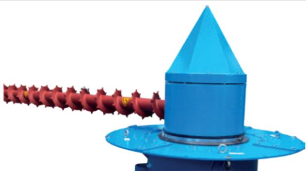
Struttura massiccia in grado di sopportare pesi specifici apparenti estremi tipici dei sistemi di estrazione da silo a torre. Trova particolare applicazione per i trucioli e per i locali stoccaggio di maggior diametro.
