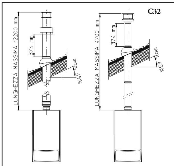
**Installazione diaframma per separatore Ø 80/80.** Per un corretto funzionamento della caldaia è obbligatorio installare sopra la camera stagna e prima del condotto di aspirazione un diaframma (vedi figura). La scelta del diaframma appropriato sul condotto di scarico avviene in base al tipo di installazione e alla sua massima estensione. Detto calcolo si può effettuare con l'utilizzo delle seguenti tabelle:
