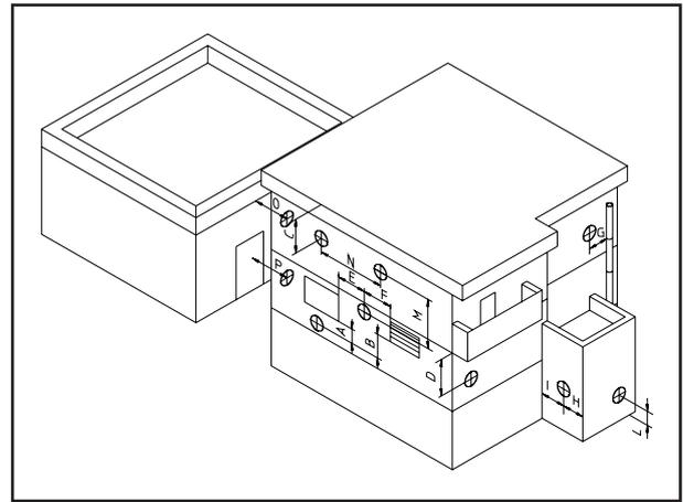
**Scarico dei prodotti della combustione di apparecchi a tiraggio forzato entro spazi chiusi a cielo libero.** Negli spazi a cielo libero chiusi su tutti i lati (pozzi di ventilazione, cavedi, cortili e simili), è consentito lo scarico diretto dei prodotti della combustione di apparecchi a gas a tiraggio naturale o forzato e portata termica oltre 4 e fino a 35 kW, purché siano rispettate le condizioni di cui alla normativa tecnica vigente (UNI 7129:2001 par. 5.7).
