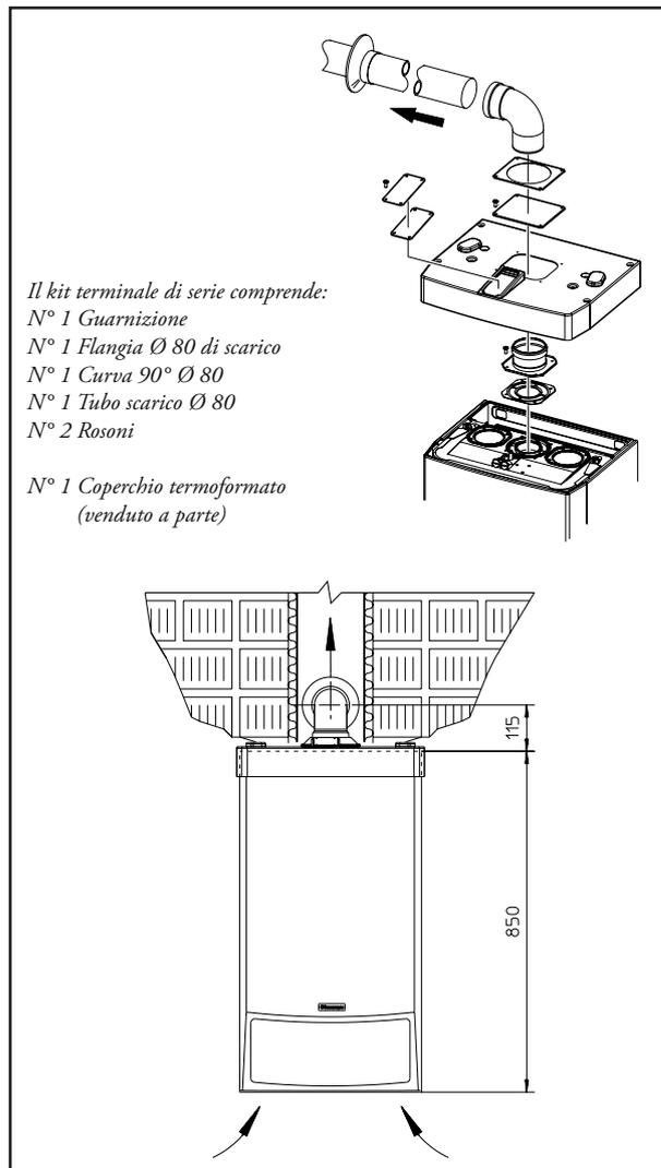
**Esempio di installazione con terminale verticale.** Utilizzando il terminale verticale per lo scarico diretto dei prodotti della combustione è necessario rispettare la distanza minima di 300 mm dal balcone sovrastante.
