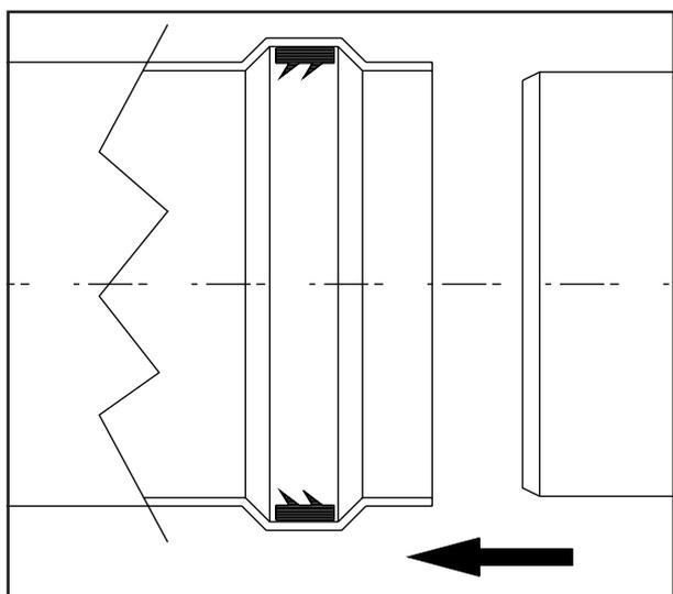
**Installazione diaframma.** Per un corretto funzionamento della caldaia è necessario installare sull'uscita della camera stagna e prima del condotto di aspirazione e scarico un diaframma (vedi figura). La scelta del diaframma appropriato avviene in base al tipo di condotto e alla sua massima estensione: detto calcolo si può effettuare con l'utilizzo delle tabelle:
