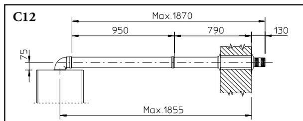
Collegamento con N°1 prolunga. Max. distanza fra asse verticale caldaia e parete esterna mm 1855.
