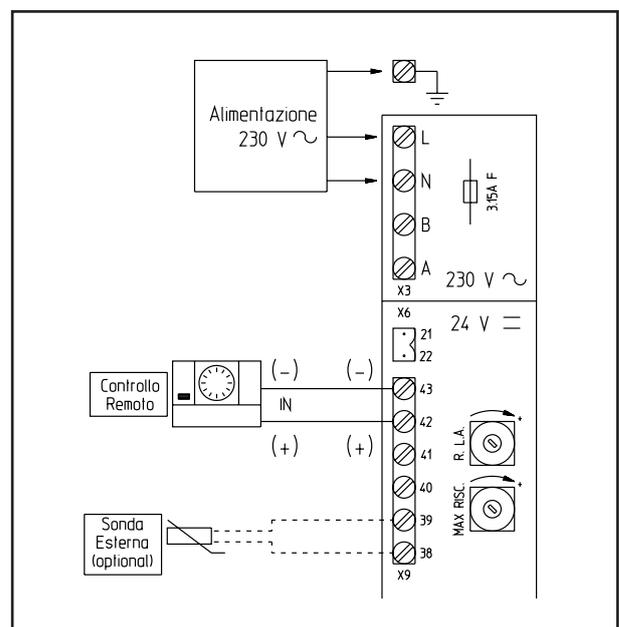
**Importante:** si rende obbligatorio predisporre due linee separate per l'alimentazione della caldaia e il collegamento al Comando Amico Remoto secondo le norme vigenti riguardanti gli impianti elettrici. Tutte le tubazioni della caldaia non devono mai essere usate come prese di terra dell'impianto elettrico o telefonico. Assicurarsi quindi che ciò non avvenga prima di collegare elettricamente la caldaia.
