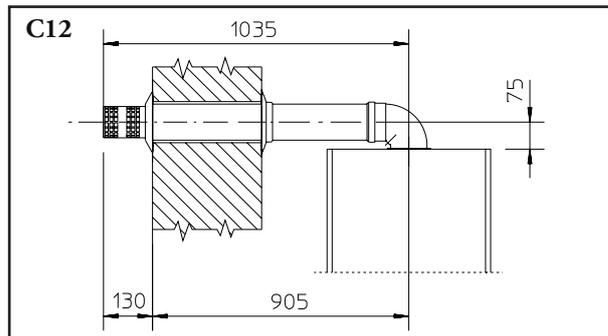
• Prolunghe per kit orizzontale. Il kit orizzontale di aspirazione-scarico Ø 60/100 può essere prolungato fino a una misura max. di 3000 mm orizzontali, compreso il terminale grigliato ed esclusa la curva concentrica in uscita dalla caldaia. Tale configurazione corrisponde ad un fattore di resistenza uguale a 100. In questi casi è necessario richiedere le apposite prolunghe.
