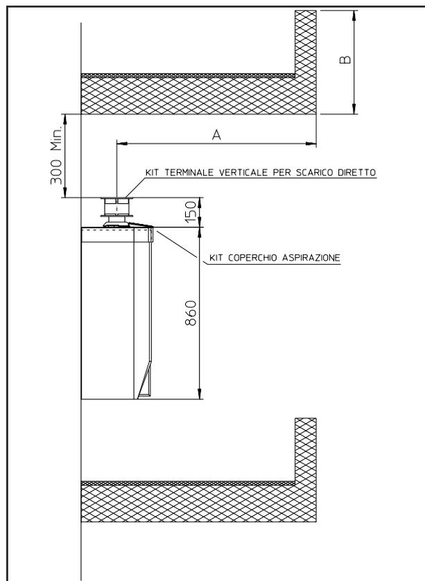
**Installazione diaframma.** Per un corretto funzionamento della caldaia è necessario installare sull'uscita della camera stagna e prima del condotto di aspirazione e scarico un diaframma Ø 46 (vedi fig. pag. 9).
