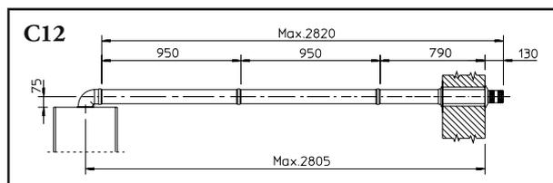
Collegamento con N°2 prolunghe. Max. distanza fra asse verticale caldaia e parete esterna mm 2805.
