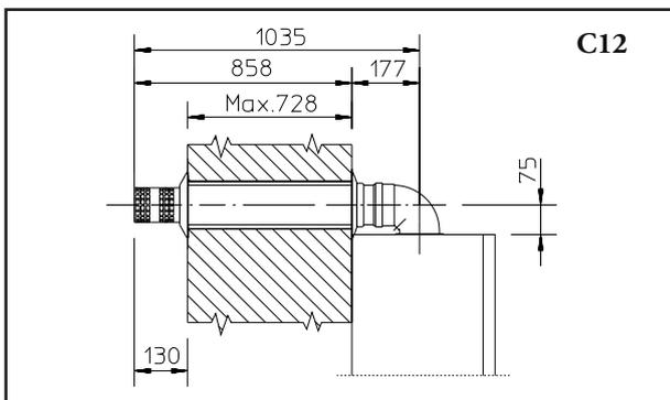
• Applicazione con uscita laterale; Utilizzando il solo kit orizzontale aspirazione-scarico, senza le apposite prolunghe, la distanza massima fra l'asse verticale di scarico e la parete esterna è di 905 mm.
