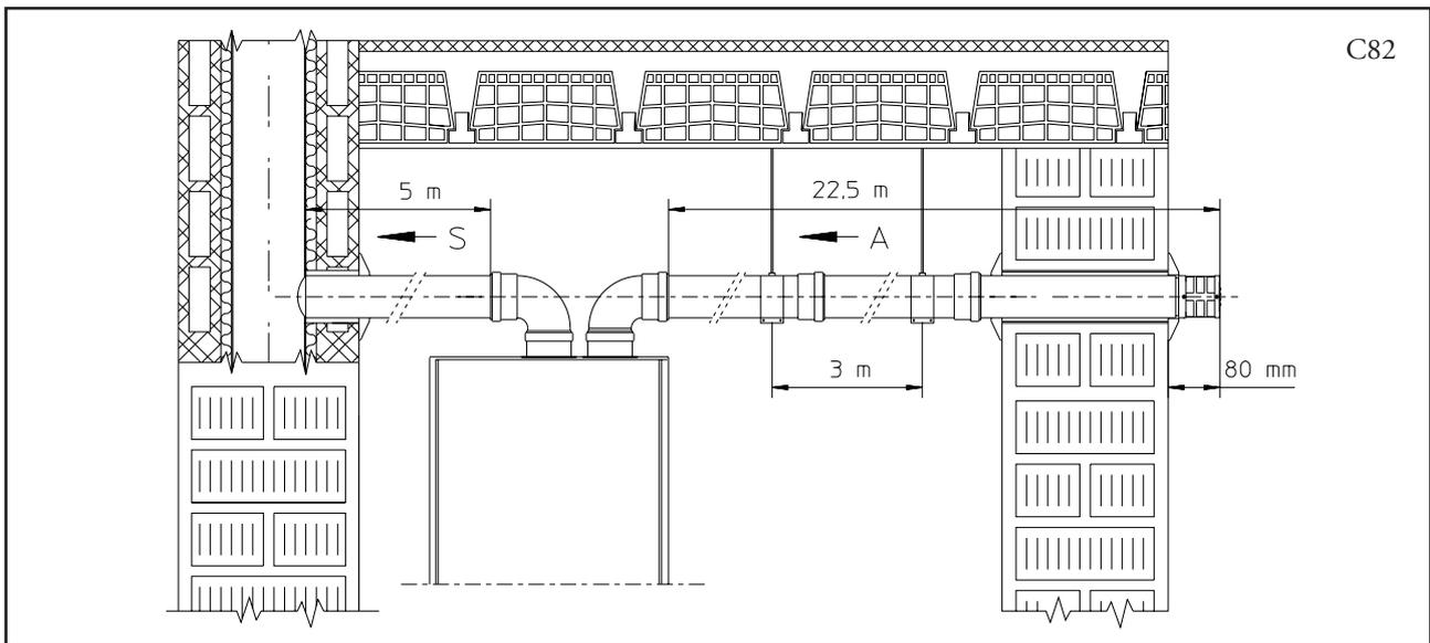
**N.B.:** durante l'installazione dei condotti Ø 80 è necessario installare ogni 3 metri una fascetta rompitratta con tassello.
