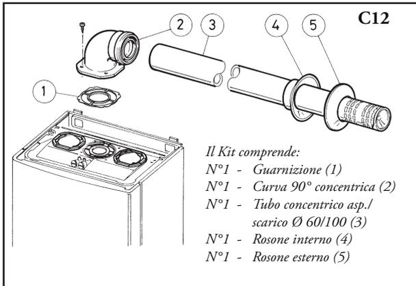
• Giunzione ad innesto di tubi o prolunghe e gomiti concentrici Ø60/100. Per installare eventuali prolunghe ad innesto con gli altri elementi della fumisteria, occorre operare come segue: innestare il tubo concentrico o il gomito concentrico con lato maschio (liscio) nel lato femmina (con guarnizioni a labbro) dell'elemento precedentemente installato sino a portarlo in battuta, in questo modo si otterrà la tenuta e la giunzione degli elementi correttamente.
