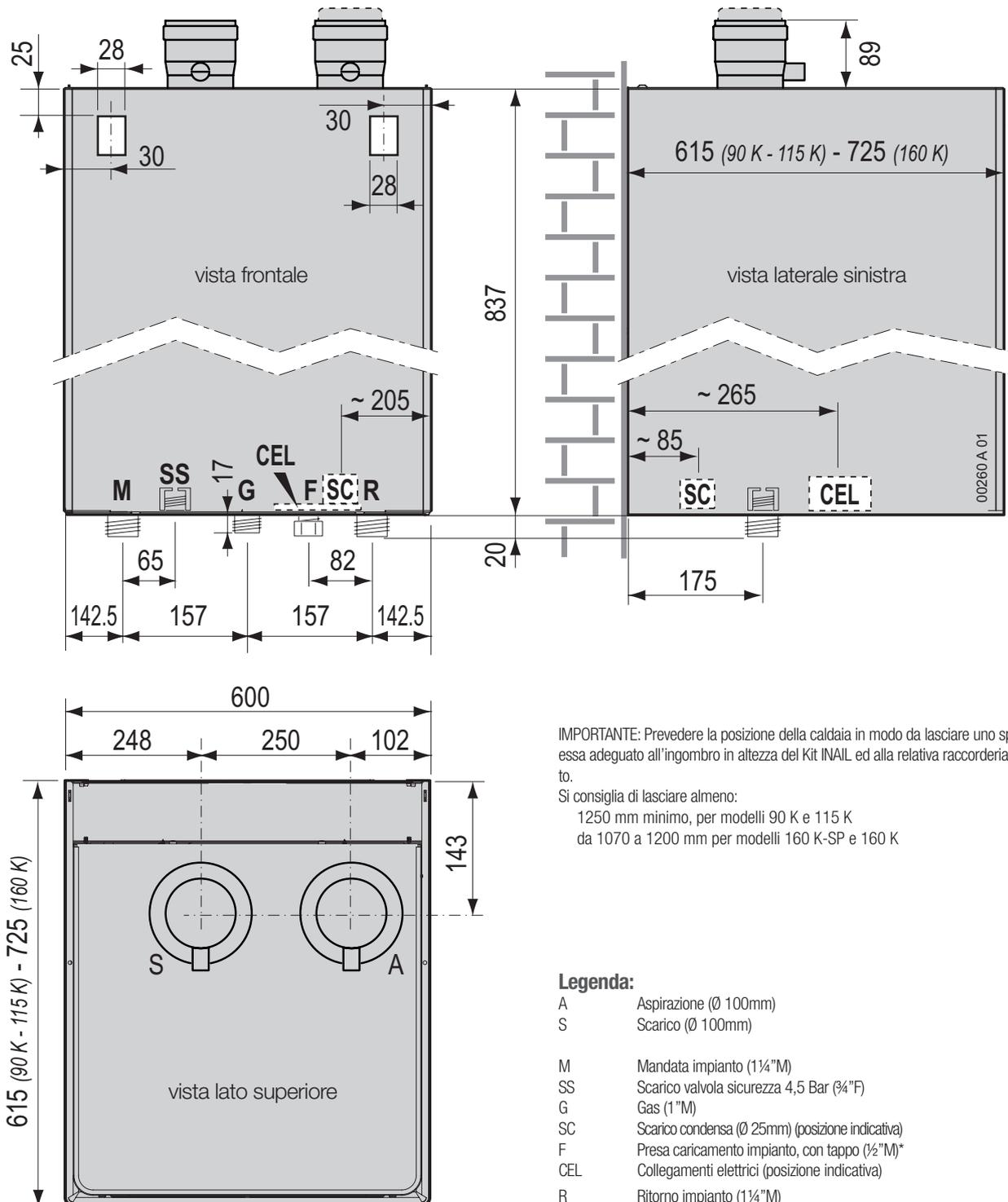
**IMPORTANTE:** Prevedere la posizione della caldaia in modo da lasciare uno spazio sotto di essa adeguato all'ingombro in altezza del Kit INAIL ed alla relativa raccorderia di collegamento.
