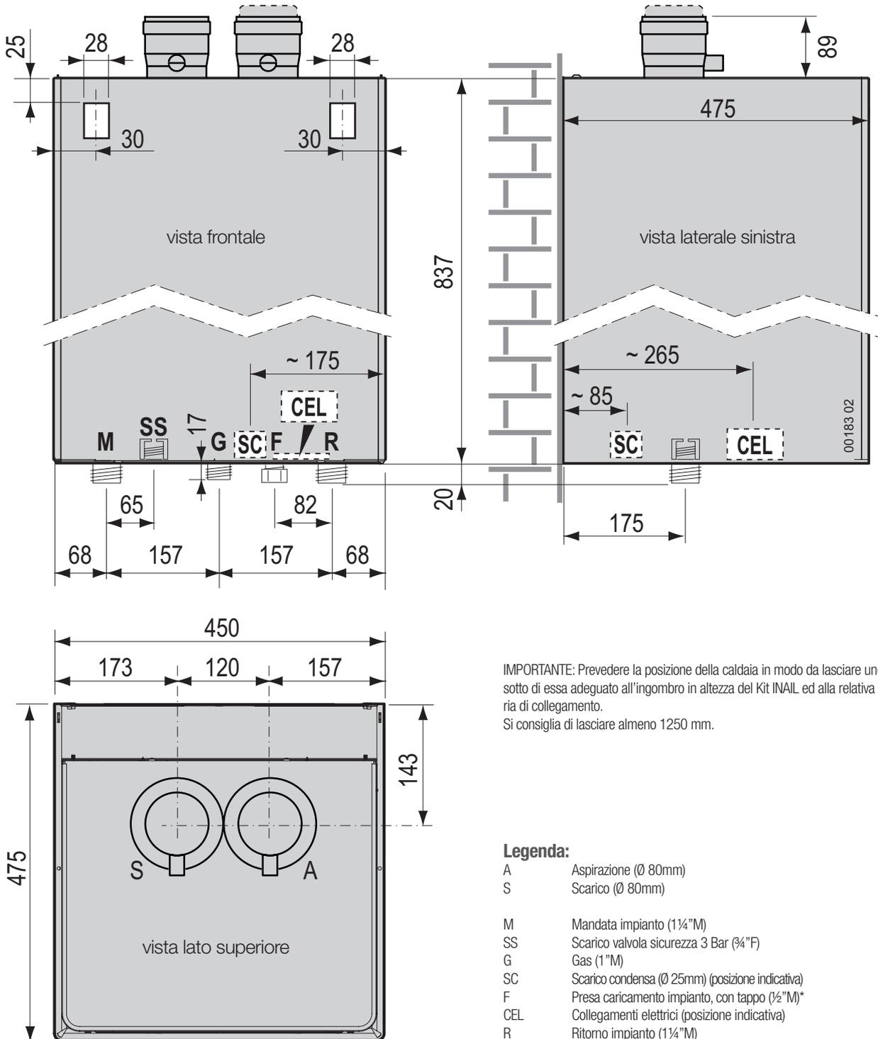
**IMPORTANTE:** Prevedere la posizione della caldaia in modo da lasciare uno spazio sotto di essa adeguato all'ingombro in altezza del Kit INAIL ed alla relativa raccorderia di collegamento.
