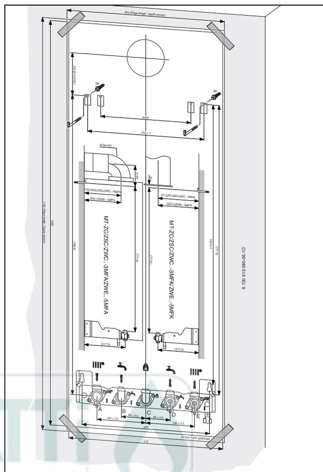
Fig. 7 Dima di preinstallazione
