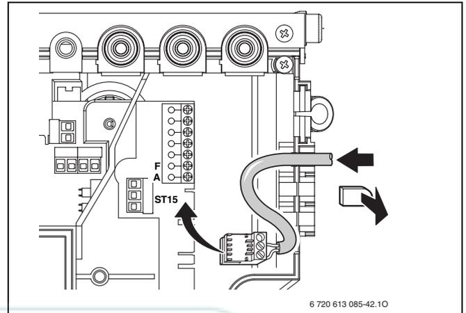
Fig. 26 Collegamento sonda della temperatura del bollitore (NTC)
