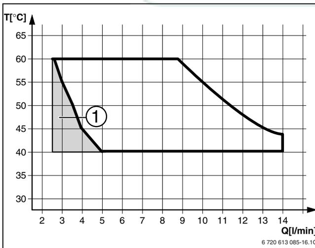
Fig. 36 Diagramma per una temperatura in entrata dell'acqua fredda di +15°C (ZWC 28-3...)
