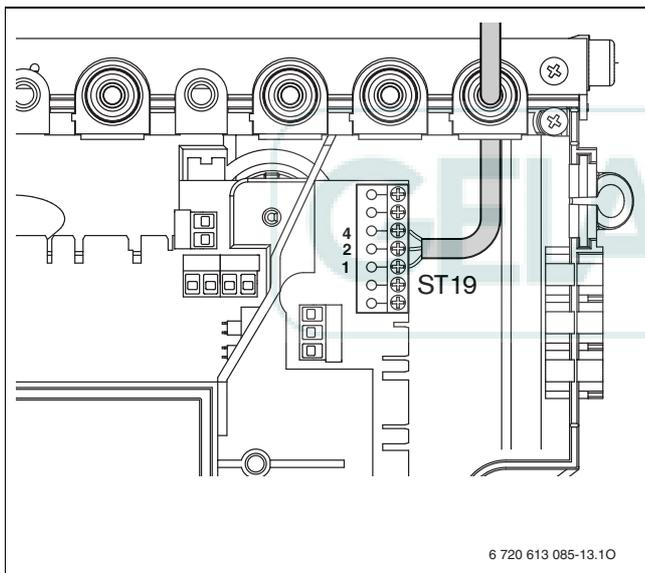
Fig. 25 Collegamento regolatore 24 V
