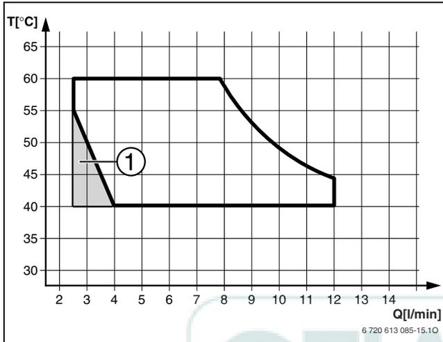
Fig. 35 Diagramma per una temperatura in entrata dell'acqua fredda di +15°C (ZWC 24-3...)
