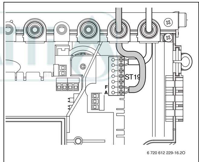
Fig. 24 Allacciamento della sonda esterna
