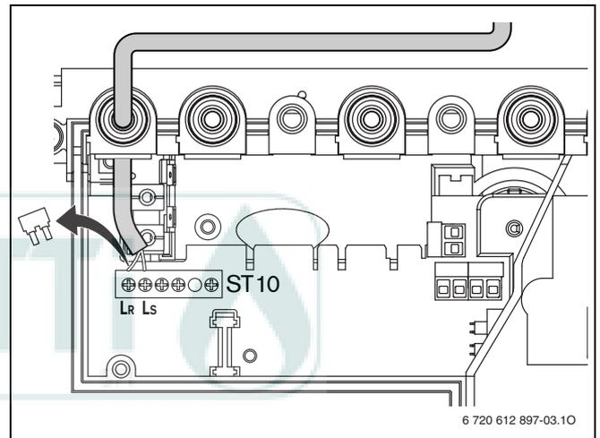
Fig. 22 Collegamento (230 V CA, rimuovere il ponte tra L<sub>S</sub> e L<sub>R</sub>)
