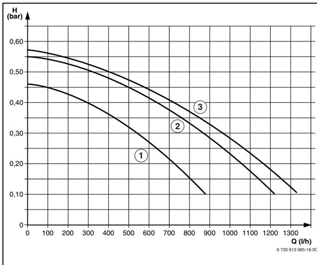
Fig. 43 Linee caratteristiche delle pompe in ZWC/ZSC 28-3 (senza piastra d'installazione)
