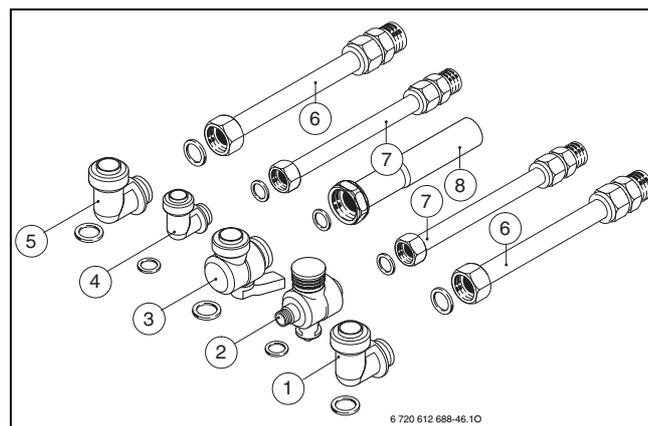
Fig. 10 Accessorio raccordi di collegamento nr. 1151
