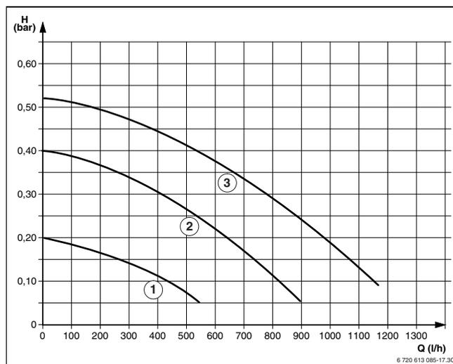
Fig. 42 Curve caratteristiche delle pompe in ZWC/ZSC 24-3 (senza piastra d'installazione)
