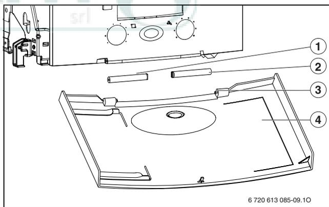
Fig. 14 Montaggio dello sportello
