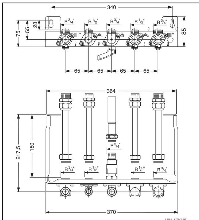
Fig. 8 Tubazioni a vista, realizzate in rame con brasatura
