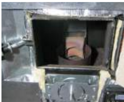
Caldaia con bruciatore integrato Boiler with integrated burner Chaudière avec brûleur intégré Kessel mit integriertem Brenner Caldera con quemador integrado Λέβητα με ενσωματωμένο καυστήρα
