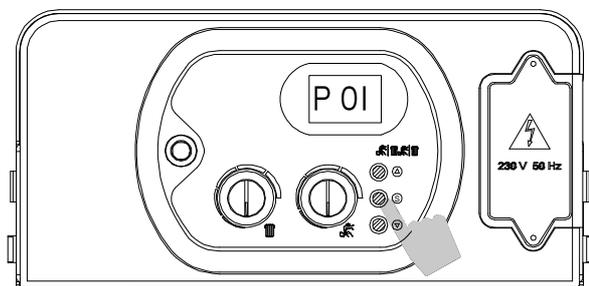
5. Rilasciare il tasto 'S', poi ripremerlo e rilasciarlo: il display visualizzerà il valore parametro da modificare.
