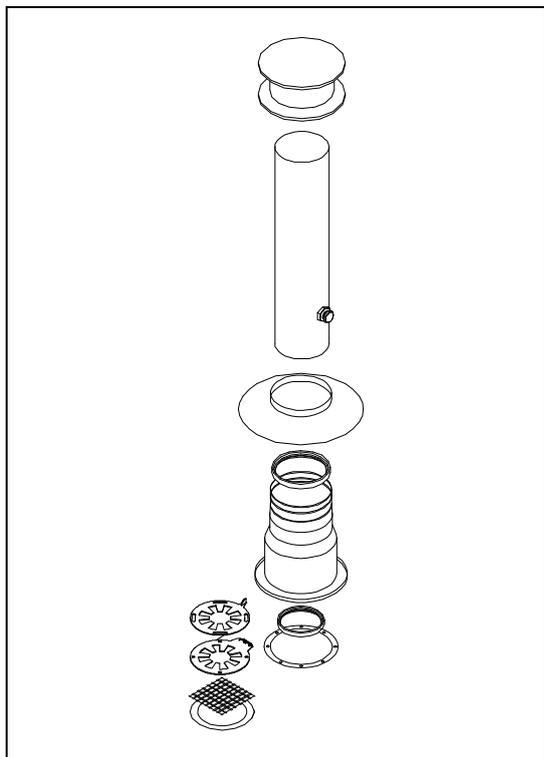
E' adatto solo per **caldaie a camera stagna**. Permette di scaricare i gas della combustione direttamente a tetto.
