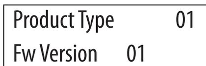
Appena la stufa sarà alimentata sul display comparirà la scritta "Product Type" e "Firmware Version" lampeggianti per alcuni secondi, finché automaticamente non avrà eseguito tutti i controlli poi apparirà senza più lampeggiare il valore di fabbrica impostato. A questo punto la stufa proporrà la prima schermata di utilizzo delle funzioni.
