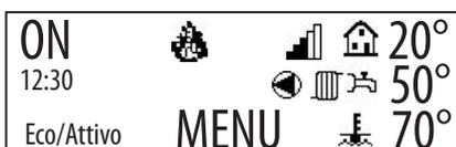
Icona lampeggiante se avviene una richiesta calore da riscaldamento altrimenti non appare
