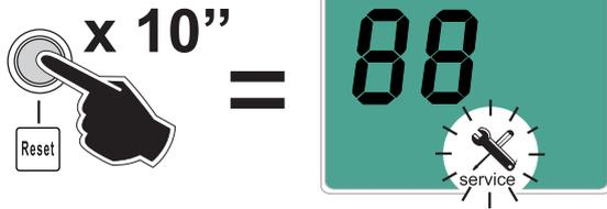
Premendo il pulsante (D) per 10 secondi, si attiva la funzione quando la chiave compare sul display in modo lampeggiante
