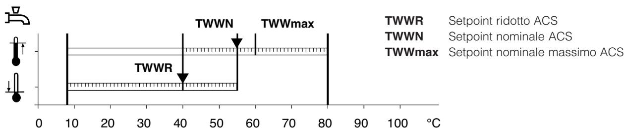
Il carico ACS è attivato quando la temperatura ACS è inferiore al setpoint meno 5K (param. 5024) ed è disattivato quando la temperatura ACS raggiunge il setpoint nominale.
