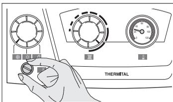
En cas d'anomalies d'allumage ou de fonctionnement, le groupe thermique effectuera un "ARRET DE BLOCCAGE" signalé par le "bouton/voiant" rouge placé sur le brûleur et par la signalisation rouge du panneau de commande.
