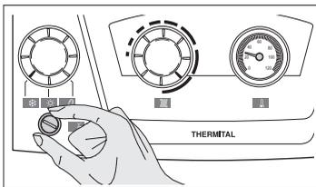
Em caso de anomalias de acendimento ou de funcionamento, o grupo térmico efectuará uma "PARAGEM DE BLOQUEIO" e o indicador vermelho do painel de controlo acende-se.
