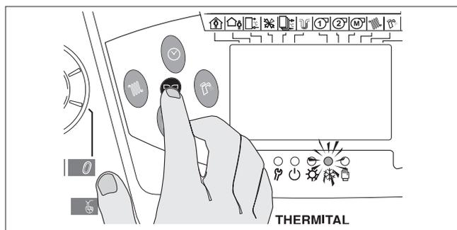
Il gruppo termico effettuerà la fase di avviamento e resterà in funzione in modalità "climatica", secondo i parametri preimpostati, fino a quando saranno state raggiunte le temperature regolate.
