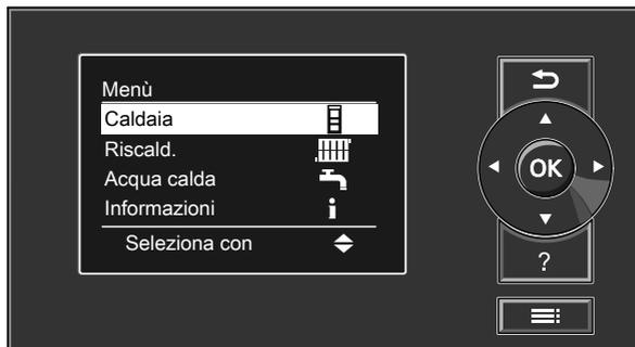
Nel menù ampliato è possibile inserire e richiamare impostazioni dalla gamma delle funzioni della regolazione **di uso meno frequente** quali ad es. l'impostazione del programma ferie e la programmazione delle fasce orarie.
