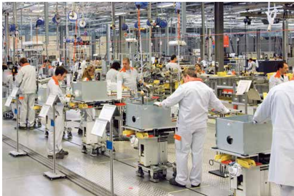
Linea montaggio caldaia a condensazione nella sede centrale di Allendorf
