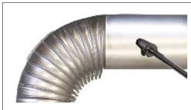
Figura: Misurazione gas combusti CGU-2(K)
