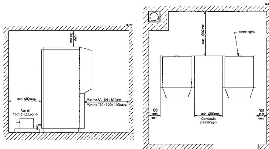
La caldaia deve avere una buona accessibilità per la messa in esercizio e per i lavori di manutenzione. Nessuna condotta, o altra installazione fissa, deve creare ostacolo alla sua accessibilità.
