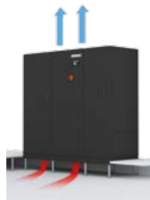
Esecuzione con aspirazione dal basso con sottobase per pavimento sopraelevato, pannello frontale cieco e mandata dell'aria verso l'alto.
