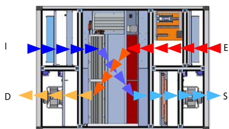
RPF V Configurazione Verticale mandata destra (vista dal lato accessibile)
