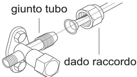
2. Togliere il cappuccio a vite della valvola e posizionare il giunto del tubo nella svasatura del tubo.
