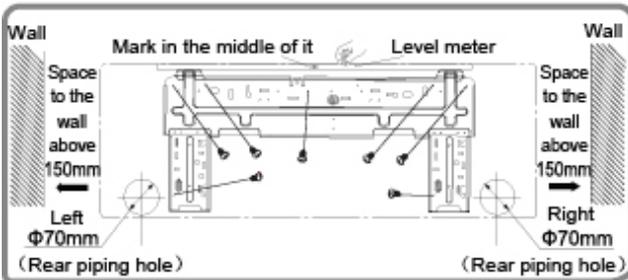
Praticare il foro tubazioni di diametro  $\Phi 55$  o  $\Phi 70$  nella posizione d'uscita appositamente scelta. Per un drenaggio corretto, il foro tubazioni sulla parete deve essere leggermente inclinato verso il basso sul lato esterno, con pendenza di  $5-10^\circ$ .
