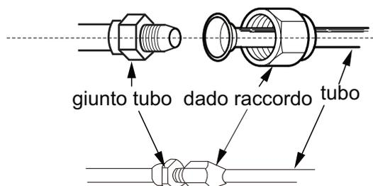
Regolare la forza della coppia facendo riferimento alla tabella seguente. Posizionare la chiave a forchetta sul giunto del tubo e la chiave dinamometrica sul dado del raccordo. Serrare il dado con la chiave.
