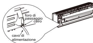
3. Rimuovere la clip del cavo, collegare il cavo di alimentazione alla morsettiere a seconda del colore; serrare la vite e fissare il cavo di alimentazione con la clip.
