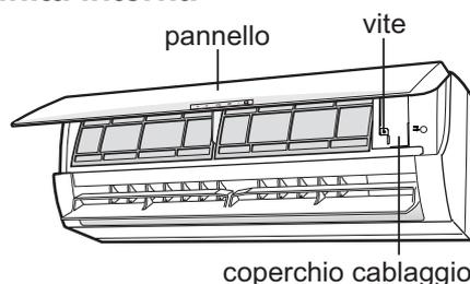
2. Inserire il cavo di collegamento tra l'unità interna ed esterna nel foro posteriore corrispondente alla morsettiere. Poi estrarlo dal lato anteriore.
