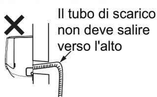
• Inclinare leggermente il tubo di scarico verso il basso. Il tubo di scarico non deve essere curvato, sollevato, ondeggiante, ecc.
