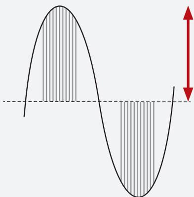
Nella regolazione PAM in corrente continua, si ha una variazione dell'ampiezza dell'impulso riproducendo una condizione in cui la frequenza è fissa e la tensione viene incrementata. In queste situazioni il compressore lavora ad alta velocità per raggiungere rapidamente la temperatura di set point impostata.
