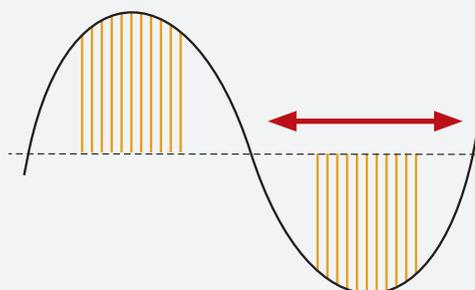
Nella regolazione PWM in corrente continua, si ha una variazione della larghezza dell'impulso riproducendo una condizione in cui la tensione è mantenuta fissa mentre la frequenza viene fatta variare per regolare finemente la velocità del compressore.
