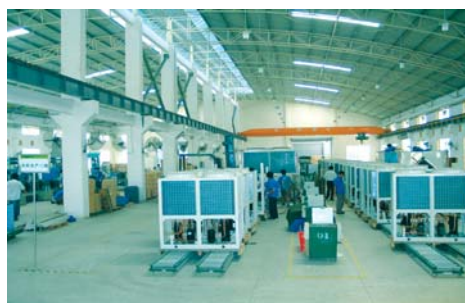
Produzione air chiller
