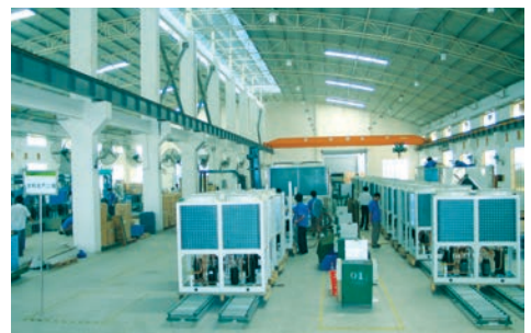
Produzione air chiller
