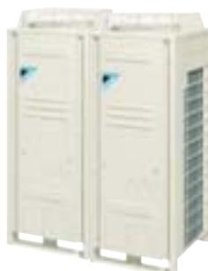
Daikin estende la propria gamma con l'esclusivo sistema Replacement VRV, una soluzione dai costi contenuti per **la sostituzione** dei sistemi VRV che ancora utilizzano il refrigerante **R-22** ora vietato. Questo upgrade a basso costo è possibile grazie al fatto che le unità esterne VRVIII-Q possono essere installate mantenendo le tubazioni già presenti e, in alcuni casi, anche le unità interne esistenti.
