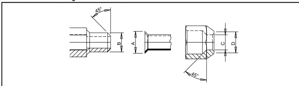
**N.B. :** s'assurer que l'huile utilisée pour la lubrification du dudgeon est du même type ou compatible avec l'huile utilisée dans le circuit frigorifique
