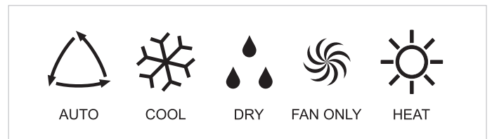
Fig. 7.11 Modos de funcionamiento.
