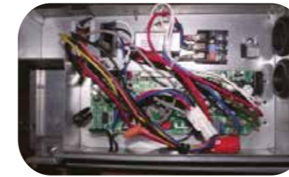
IDU PCB Scheda elettronica unità interna
