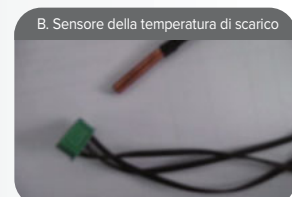
B. Sensore della temperatura di scarico
