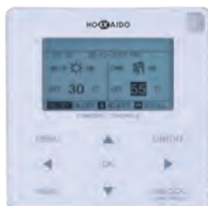
Modalità operativa RISCALDAMENTO + ACS
