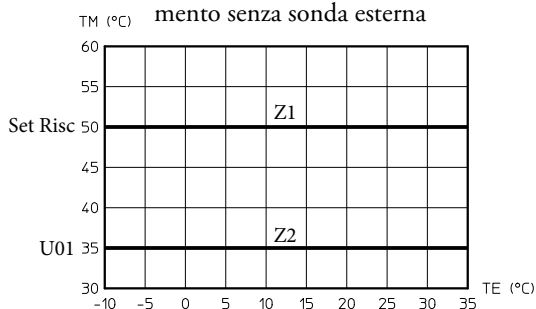
Temperatura di mandata in fase riscaldamento senza sonda esterna
